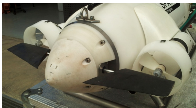
Figura 5. Mòdul dels timons de profunditat acoblat a l'SPARUS II amb les pales NACA 0015
