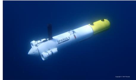
Fig. 1: SPARUS-II, a torpedo-shaped AUV.
